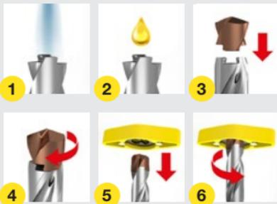
1. Schnittstelle mit Luftdruck reinigen.
