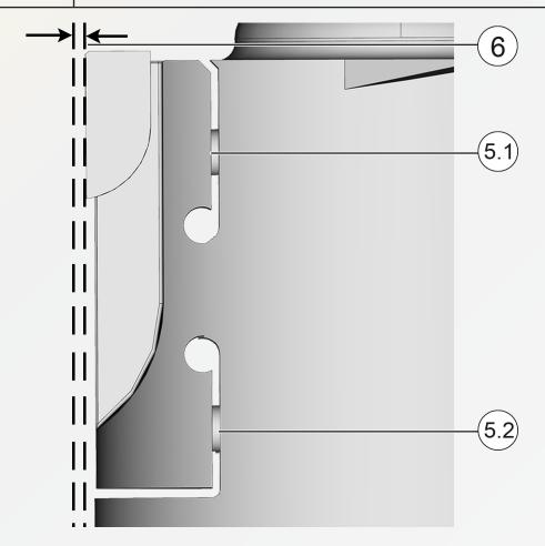
Ajuste el filo con ayuda del husillo de ajuste (5.1) a la medida de ajuste de diámetro (6) deseada. Para ello gire el tornillo de ajuste (3.1) en sentido horario. Use para ello una llave dinamométrica y respete los torques indicados en el capítulo "5.7 Torques".
