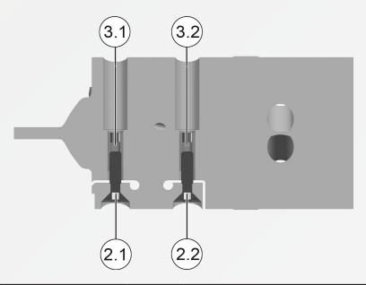
2.1 / 2.2 Tornillo de cabeza avellanada 3.1 / 3.2 Tornillo de ajuste con rosca interior y exterior
