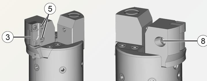
Fig. 6: Vis d'ajustage pour réglage du serrage de filetage, porte-plaquette et vis de serrage du porte-plaquette
