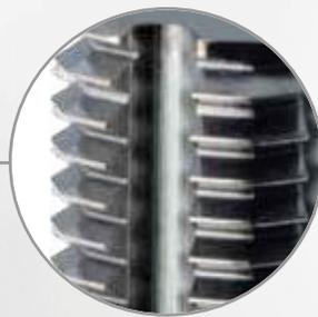
Grâce à la modification de la géométrie polygonale, la surface en contact entre l'outil et la pièce est vigoureusement optimisée.
