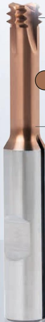
Durch die **linksschneidende Geometrie** stabilisiert sich das Werkzeug beim Gewindefräsen im Gleichlauf – einwandfreie, lehrenhaltige Gewinde sind bis 66 HRC gewährleistet.
