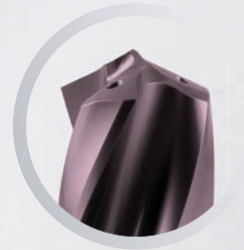
Pyramidenspitze unterbindet die radiale Abdrängung beim Anbohren
