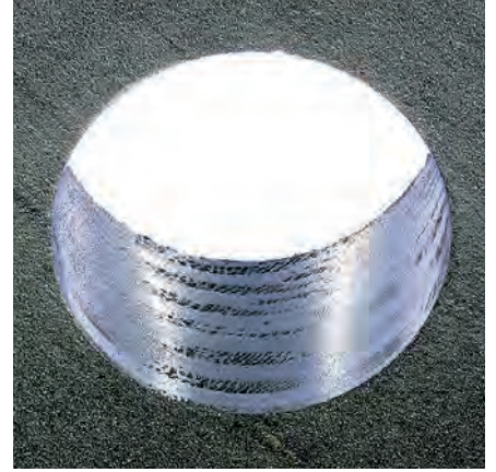
Delik Çapı D = 6,35 mm Yönlenmemiş CFRP optimum işleme kalitesi
