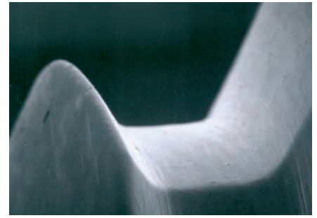
Gühring Profile- ovalama kılavuzunun ideal yüzeyi
